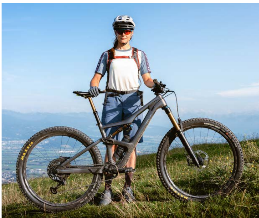
Image 3-7 : VTT à suspension avant et arrière (Fully)
