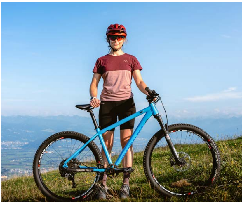
Image 3-6 : VTT à suspension avant uniquement (Hardtail)
