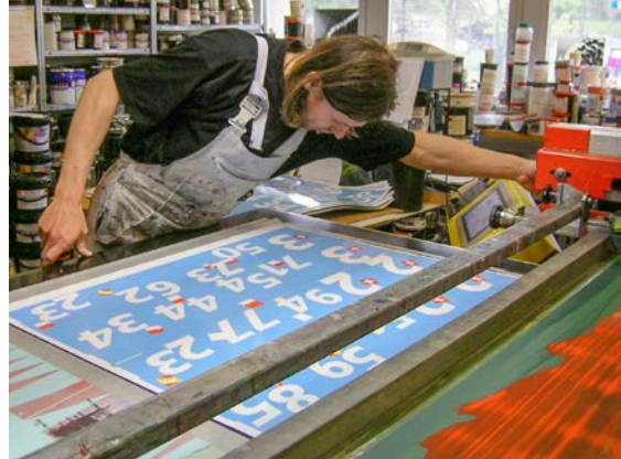
Lorenz Boegli an der Siebdruckmaschine beim Drucken der langlebigen Routenfelder.
